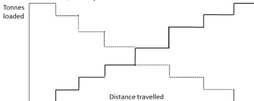
Figur 2. Schematisk bild över en kombinerad distributions- och uppsamlingsrunda (från Eurostats manual 2011, sid 6-15)
