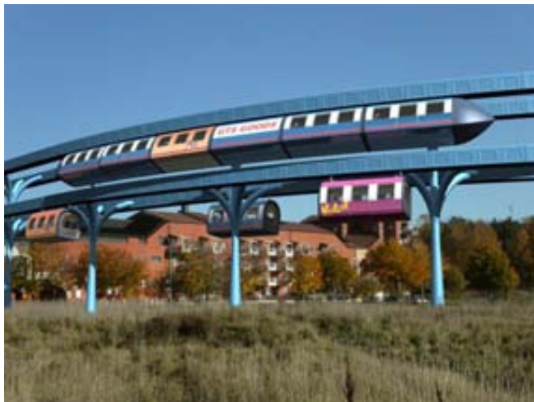
Figur 3.2. Tågbildning vid hög hastighet och skilda fordon vid låg hastighet. Bild: Hans Kylberg, SIKA rapport 2006:2
