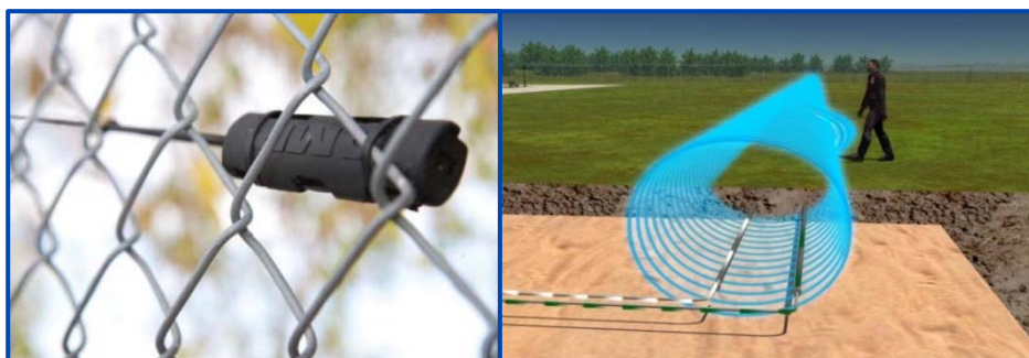
Figur 12 Bild t.v. Fysiskt monterat intrångslarm. Bild t.h. Osynligt elektrostatiskt intrångslarm (Källa: SENSTAR Corp.)
