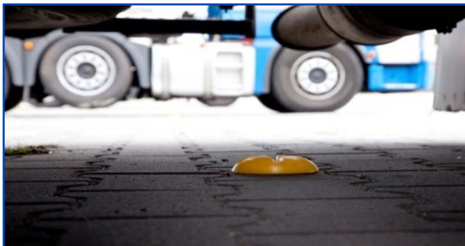
Figur 11 Trådlös parkeringssensor (foto: Nedap Identification Systems)
