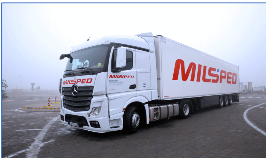
Figur 16 Släp eller semi-trailer med hårt skal ger en ökad säkerhet mot stöld jämfört med lastbil med kapell (foto: Milsped Group)
