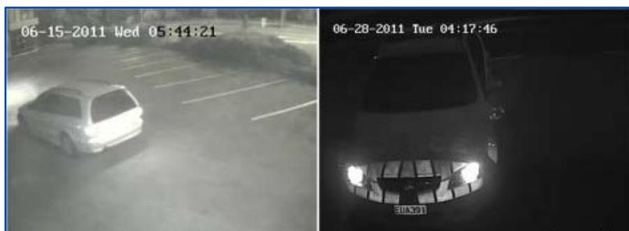
Figur 13 Vid mörker ger infraröd kameraövervakning (bild t.h.) en klart högre detaljeringsnivå i jämförelse med kamera med vanlig inspelningsteknik (bild t.v.) (foto: Trinity CCTV Solutions)
