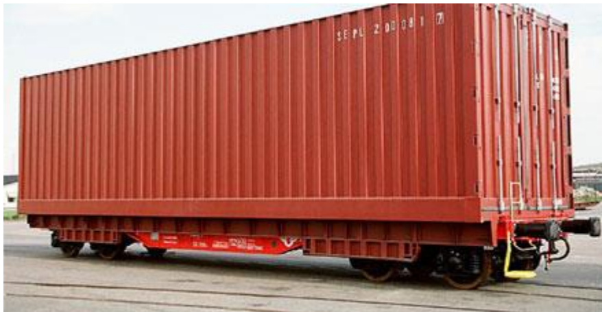
Figur 40 SECU på järnvägsvagn. 112
