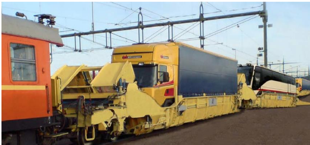
Figur 31 FlexiWaggon järnvägsvagn med dragbil och trailer. 96
