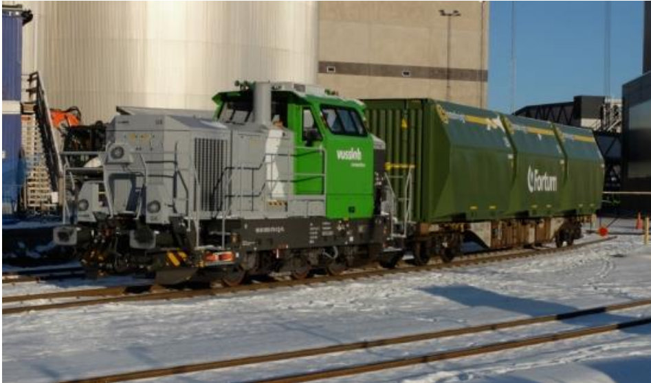
Figur 41 Fortum Värmes nya tågcontainer för flistransporter på järnväg. 113
