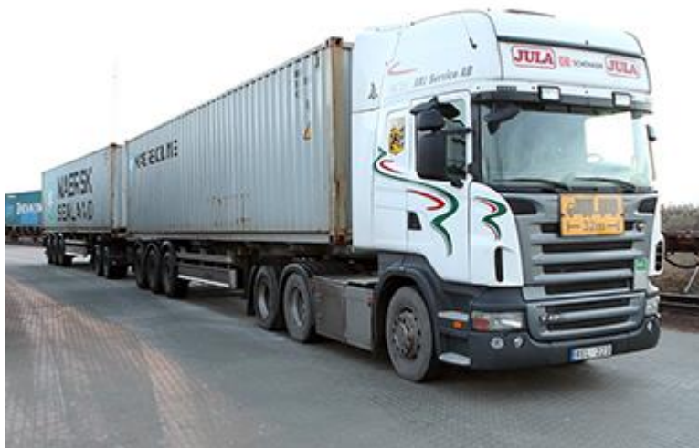
Figur 26 Dragbil och dubbeltrailer, 31,6 m med två 40-fots container. 81
