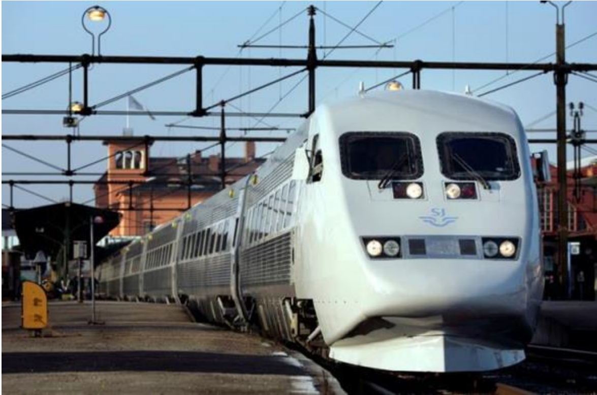
Figur 3.5: SJ 2000 som svarar för huvuddelen av SJs fjärrtrafik Stockholm-Göteborg sedan 1991. Tåget tillverkades 1990-2000 och har korglutning vilket gör att det kan köra fortare i kurvorna än konventionella tåg. Foto: SJ.
