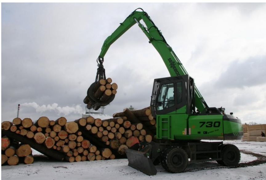
Figur 3.5 Höglyftare för rundvirkeshantering (Sennebogen)
