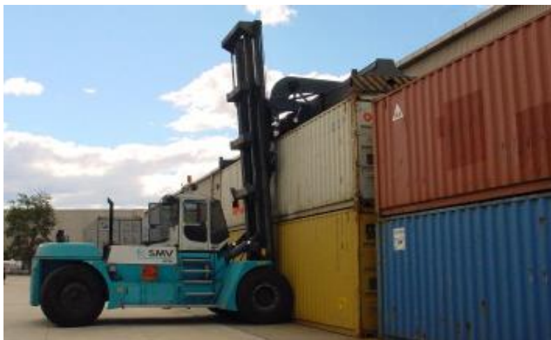
Figur 6.18 Motviktstruck med topplyftok (SMV Konecranes)
