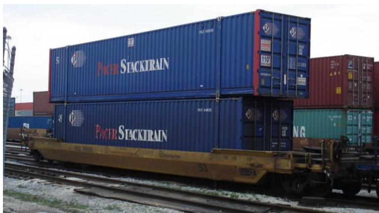
Figur 5.3 En amerikansk järnvägsvagn med en 53- samt en 48-fots container staplade på varandra (sk. double-stack) (TFK)
