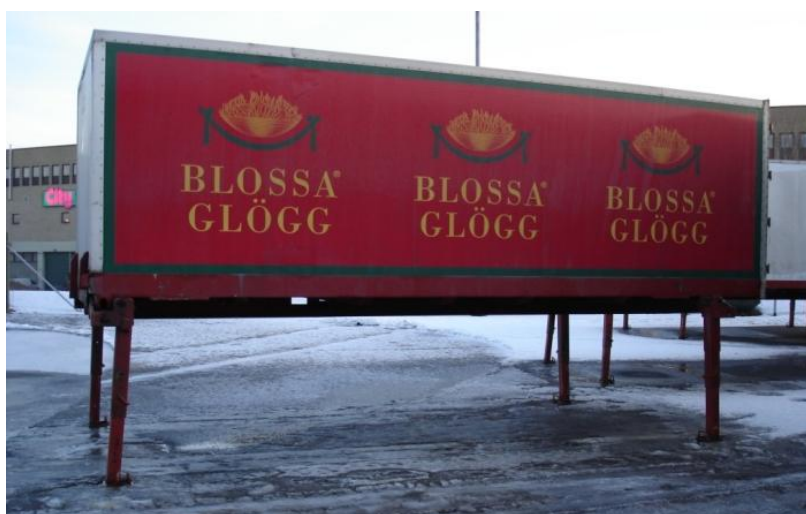
Figur 5.4 Ett växelflak klass C stående på stödben (TFK)
