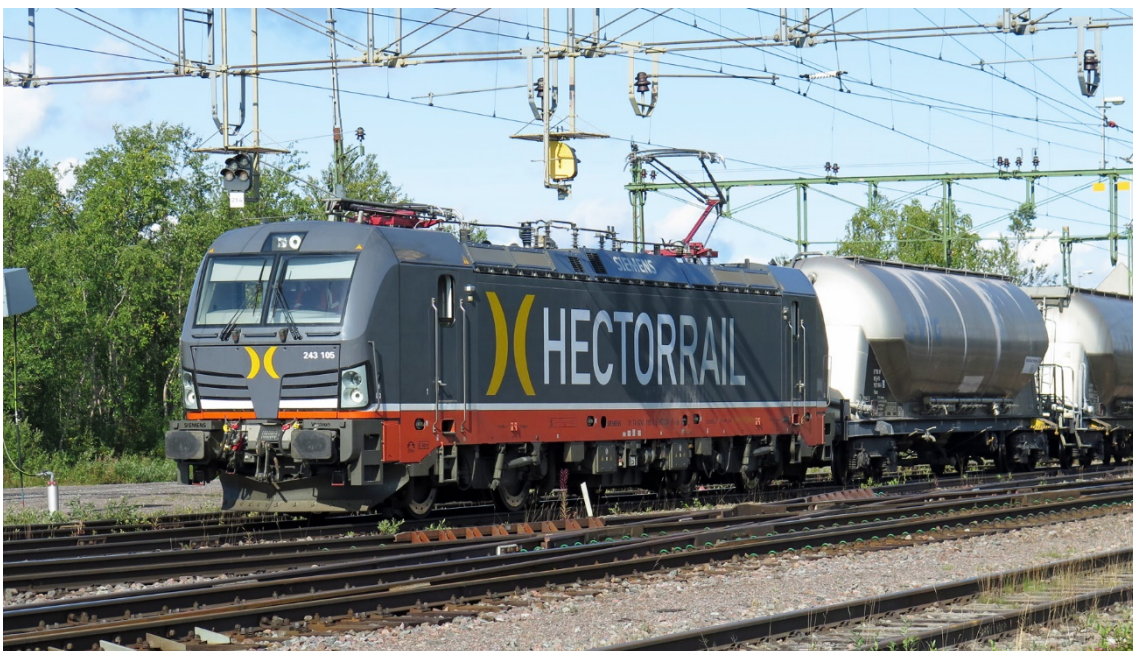
Figur 17. Exempel på ett modernt ellok utrustat med energimätare och med återmatning av bromsenergi till elnätet. Foto: Oskar Fröidh
