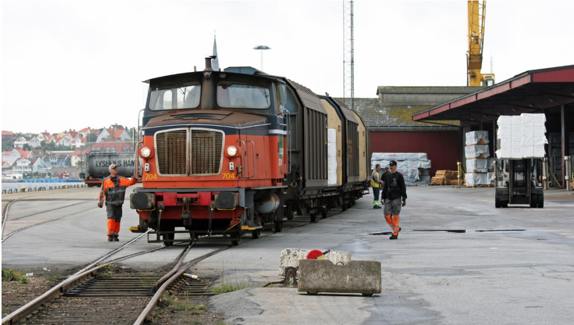
Figur 16. Ett mindre diesellok för växling särskilt på oelektrifierade spår, som här i Lysekils hamn där gods stuffas (lastas om). Foto: Oskar Fröidh
