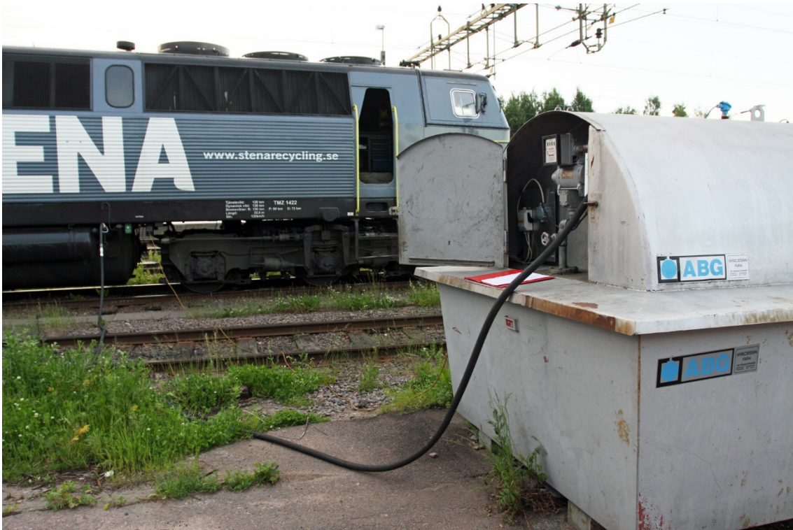
Figur 5. Tankning av ett större diesellok med flyttbar hyrtank med pump. Foto: Oskar Fröidh
