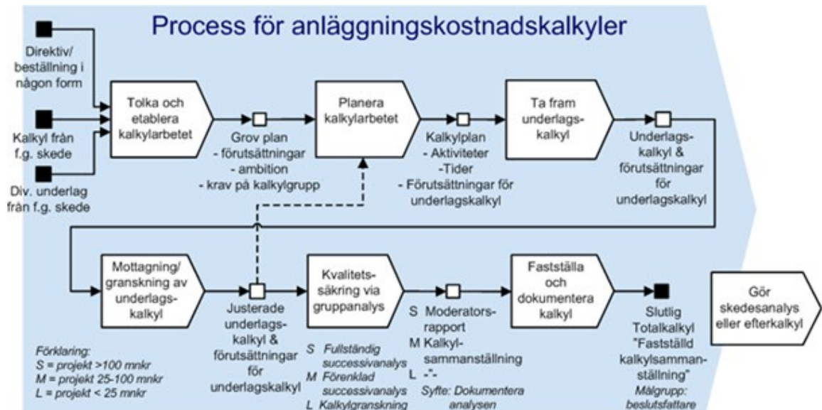
Figur 3.1. Process för anläggningskostnadskalkyler. Källa: TDOK 2011:184
