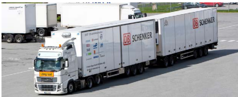
Figur 7: Duo-trailer bestående av en dragbil och en dubbeltrailer. Källa: DB Schenker.
