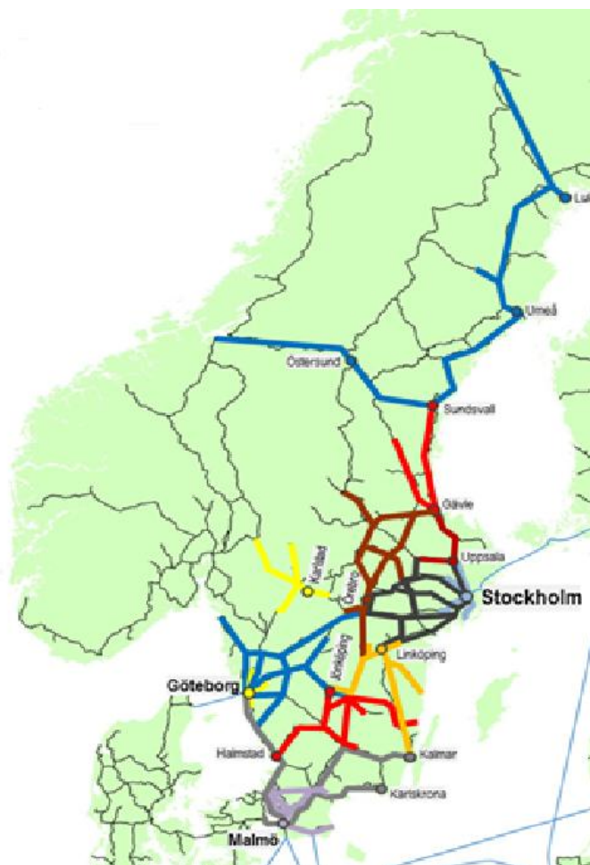
Figur 2.13: Regional tågtrafik 2013 i RKM-regi (Tågplan 2013). Linjernas olika färger indikerar olika RKM eller sammanslutningar av RKM. Källa: "Utveckling av utbud och priser på järnvägslinjer i Sverige 1990-2013", Järnvägsgruppen KTH.
