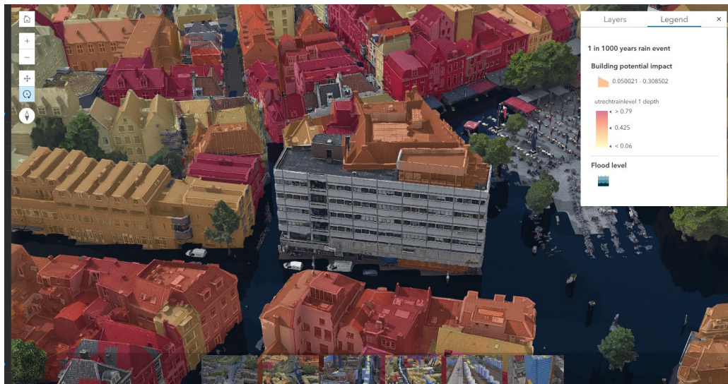
Figur 5.1. Interaktiv kartapplikation för att simulera översvämningar i 3D-modeller. Simulering av ett 1 000 år regn i centrala Utrecht. I 3D modellen visas hus i olika färger utifrån hur husen påverkas av översvämningen. Källa: (van Maren, 2022)
