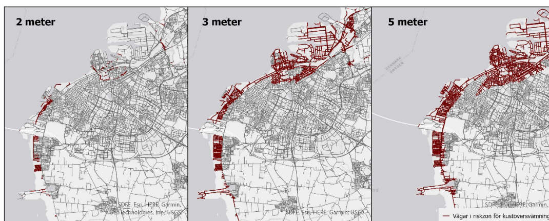
Figur 4.4. Vägnätet i Malmö som ligger i riskzon (i rött) för översvämning vid olika återkomstnivåer på 2, 3 och 5 meter.
